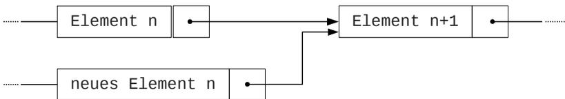
3) Nun wird der überflüssig gewordene Zeiger von Element n so umgelegt, dass er auf das neue Element zeigt. Von da ab ist das neue Element in der linearen Liste enthalten.
