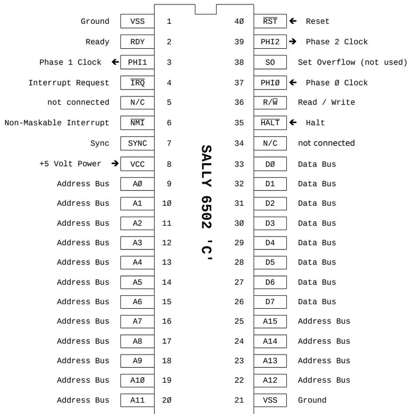
'SALLY' ist die Standard-CPU in allen XL/XE-Computern. Außerdem fand sich in allen bisher überprüften PAL-Geräten des Typs 400/800 ebenfalls bereits eine 'Sally'!
