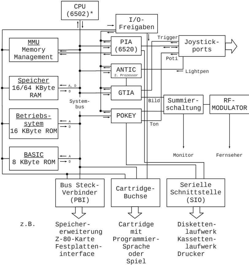
\*) Im 400/800 (PAL) sowie allen XL/XE-Computern befindet sich eine CPU 6502 'C' (=customized) genannt 'SALLY'. Darin ist vermutlich eine CPU 6502B (= 2 MHz) enthalten.
