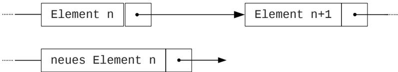
2) Dazu wird zuerst der Zeiger von Element n kopiert in den Zeiger für das neue Element:
